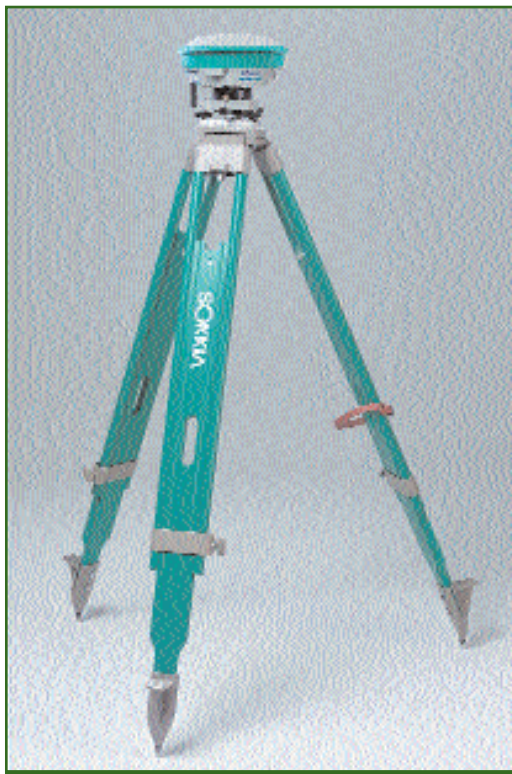
Двухчастотный приемник GPS/ГЛОНАСС Sokkia GSR2700 ISX Base
