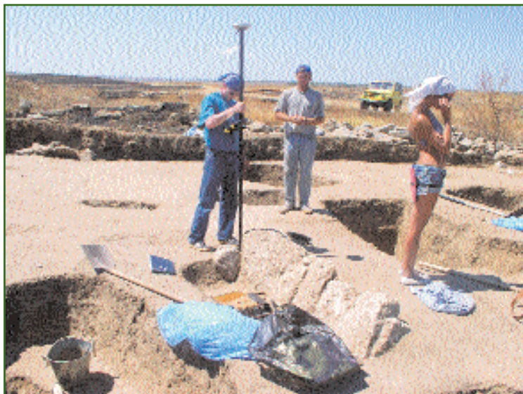
Рис. 2 Съемка с помощью подвижного приемника
